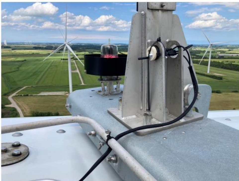
Foto: Mikrofon til flagermusdetektor monteret øverst på nacellen bag rotoren.
